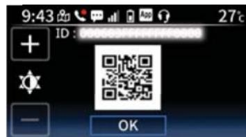
该模块包含一个二维码 CCU 的单元标识号。“ $\wedge$ ” / “ $\vee$ ”开关控制二维码的亮度。短按按“ $\checkmark$ ”键返回上一级菜单。
