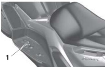
1. 冷却液储液罐盖
