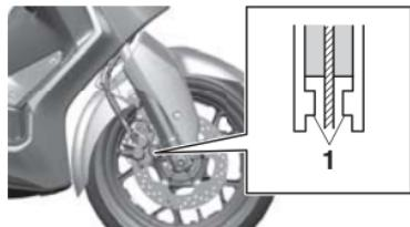
1. 制动垫槽磨损指示器
