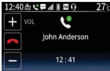
使用“ $\wedge$ ”开关增大通话音量，使用“ $\vee$ ”开关减小通话音量。短按“ $\vee$ ”开关结束通话。
