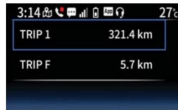
该模块允许在主显示屏上重置行程表。短按“” / “”切换可突出显示某个项目。长按“”开关可重新设置该项目。选择“确定”进行确认。
