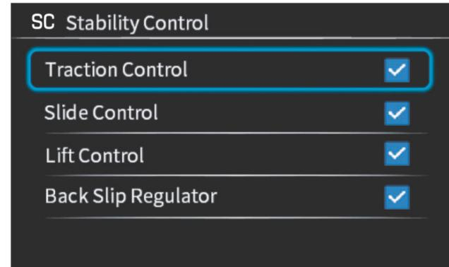
此菜单允许您启用/禁用稳定控制系统：“牵引力控制” (TCS) 、“侧滑控制” (SCS) 、“抬前轮控制” (LIF)
