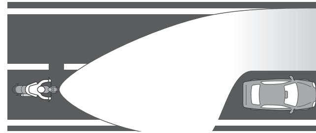
自适应远光灯关闭（转弯时）
