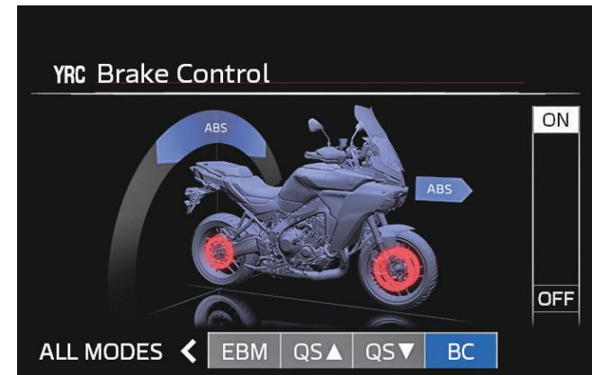
OFF：仅启用标准ABS(防抱死制动系统)，根据车辆速度和车轮速度数据调节制动力。标准ABS设计在车辆保持直立时介入并最大化制动效果。
