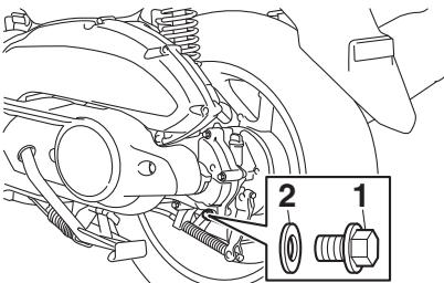
1. Palam pembuangan minyak transmisi akhir
