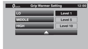
4. Untuk menetapkan tahap suhu untuk satu lagi cengkaman yang lebih hangat, ulangi dari langkah 2 atau pilih simbol segitiga untuk keluar dari modul ini.
