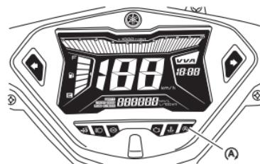
4. 要关闭停止和启动系统，请将停止和启动系统开关设置为“
