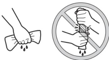
4. 将推荐类型的油涂抹到海绵材料的整个表面，然后挤出多余的油。
