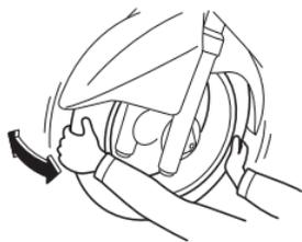
前方和后方必须检查车轮承在定期保养和润滑图表规定的时间间隔。如果在轮毂或轮不转顺利播放，联络雅马哈经销商检查车轮轴承。
