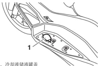
1. 冷却液储液罐盖
