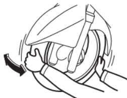
依据定期保养及润滑表，每隔一段特定的时期一定要检查前和后车轮承。若轮毂或车轮无法顺畅转动，请联络野马哈代理商检查车轮承。
